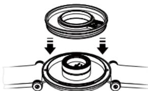
3 Intégrer la bague intérieure de votre choix en l'insérant verticalement autour du modèle horloger.
