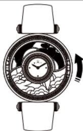
逆時針方向轉動珍珠貝母外圈約90° 便可取出錶圈。更換中圈前先取出外圈。
